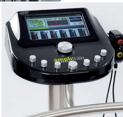
AmpliTrain® trainiert mit mittelfrequenter Strom die Muskulatur und Ausdauer
